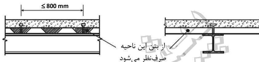
شکل ۱۰-۲-۸-۸: عرشه فولادی که کنگره‌های آن‌ها عمود بر محور تیر است
