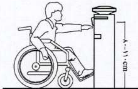
شکل شماره ۵۱: ارتفاع شکاف صندوق پست دسترس‌پذیر
